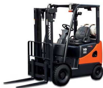
D15S / D18S-5 i D20SC-5 G15S / G18S-5 i G20SC-5 1500kg 1750kg 2000kg, Silnik wysokoprężny, LP, Opony pneumatyczne
